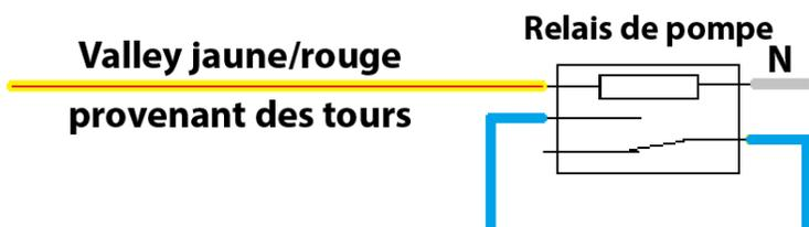
Les fils de commande de pompe/vanne d'arrêt sont connectés à ce nouveau relais au lieu de la barrette à bornes du panneau
